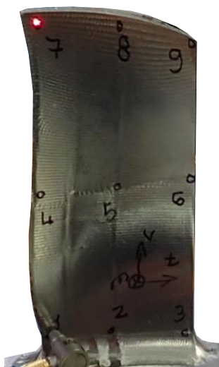
Obr. 8. Testovací lopatka obrobená na stroji MCU 700 VT-5X
