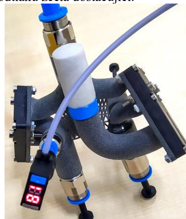
Obr. 9 Testování funkce pneumatického obvodu.
