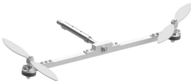
Obr. 11. Horní hřídel s ramenem a servomotory.
