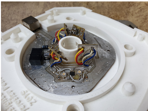
Obr. 8. Současná verze sensorového modulu (na snímku jsou senzory vyjmuty z montážních otvorů)
