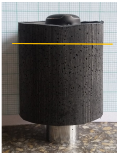
Obr. 7. Vzorek po vyjmutí z formy a očištění. Žlutě je naznačena rovina řezu.
