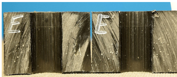
Obr. 14. Podélný řez referenčním vzorkem po vytlačení kovové tyče
