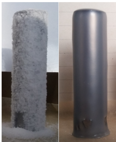
Obr. 6. Vlevo tyč s nataveným práškem (PPE N), vpravo tyč s práškem po slinutí (PPE S)
