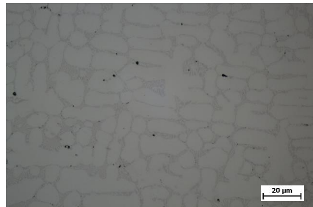
Obr. 12. Mikro struktura vzorku C6, zvětšení 500x
