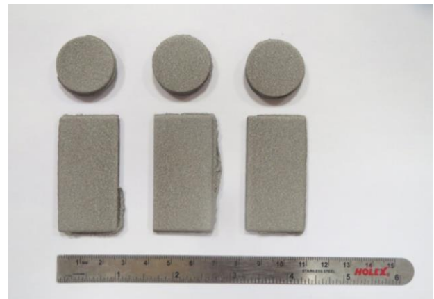
Obr. 4. Zkušební vzorky NiCrAl na podložce z litiny s kuličkovým grafitem po provedení žárového nástřiku
