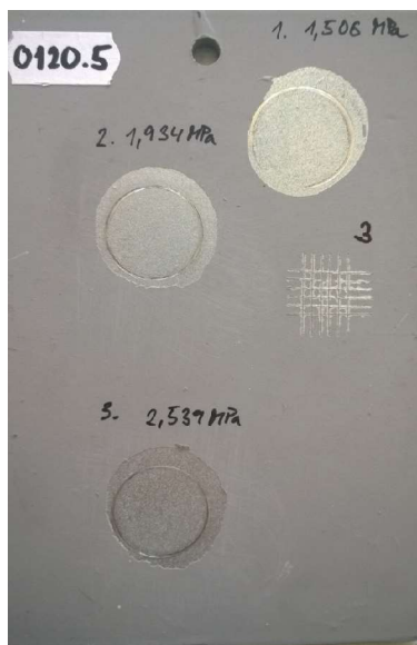
Obr. 2. Odrhové zkoušky a mřížkový test přilnavosti NH Colorlak Synorex S2000 – zinkový povrch od firmy ACO
