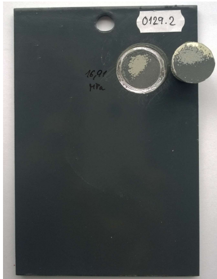
Obr. 5. Vzorek s nátěrovým systémem Atryx otryskaný hnědým korundem F40, základní nátěr Jacote universal, vrchní nátěr Normadur 65, odtrhová pernost 16,9 MPa
