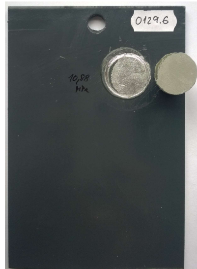
Obr. 6. Vzorek s nátěrovým systémem Atryx Neotryskaný, základní nátěr Jacote universal, vrchní nátěr Normadur 65, odtrhová pernost 10,8 MPa
