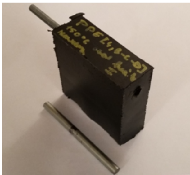
Obr. 3. Vzorek po trhačí zkoušce - spoj porušen u hladké tyče [5]
