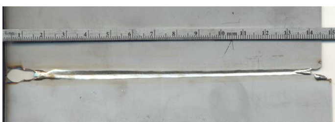
Obrázek 4.: Svar a kořen svaru pro parametry I = 151 \text{ A} ; U = 16,04 \text{ V} ; v_s = 120 \text{ cm} \cdot \text{min}^{-1} ; II
