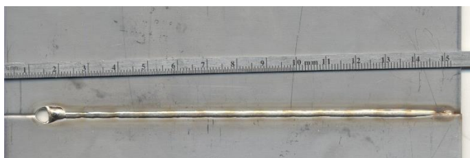
Obrázek 14.: Svar a kořen svaru pro param. I = 250 \text{ A} ; U = 20 \text{ V} ; vs = 150 \text{ cm} \cdot \text{min}^{-1} ; II
