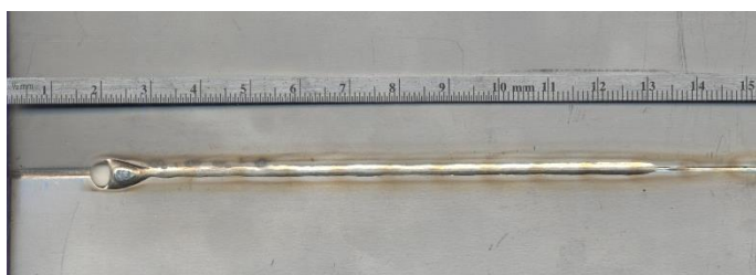
Obrázek 24.: Svar a kořen svaru pro param. I = 260 \text{ A} ; U = 20,4 \text{ V} ; vs = 150 \text{ cm} \cdot \text{min}^{-1} ; H5; vd = 1,8 \text{ m} \cdot \text{min}^{-1}
