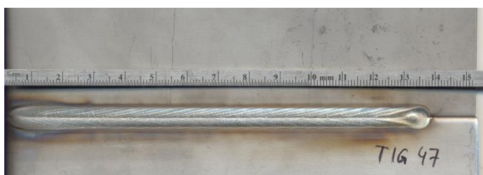
Obrázek 16.: Svar a kořen svaru pro param. I = 320 \text{ A} ; U = 22,8 \text{ V} ; vs = 180 \text{ cm} \cdot \text{min}^{-1} ; II
