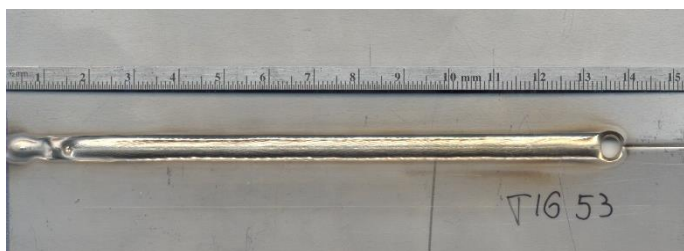
Obrázek 22.: Svar a kořen svaru pro param. I = 230 \text{ A} ; U = 19,2 \text{ V} ; vs = 120 \text{ cm} \cdot \text{min}^{-1} ; H5; vd = 1,4 \text{ m} \cdot \text{min}^{-1}
