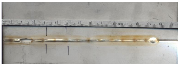
Obrázek 20.: Svar a kořen svaru pro param. I = 240 \text{ A} ; U = 19,6 \text{ V} ; vs = 120 \text{ cm} \cdot \text{min}^{-1} ; H5; vd = 1,6 \text{ m} \cdot \text{min}^{-1}
