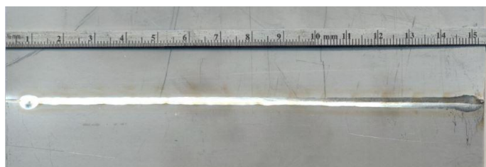
Obrázek 2.: II Svar a kořen svaru pro parametry I = 111 \text{ A} ; U = 14,4 \text{ V} ; v_s = 90 \text{ cm} \cdot \text{min}^{-1} ; II
