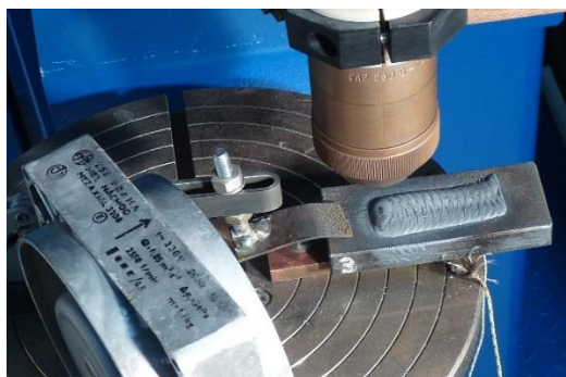
Obr. 2. Upnutí vzorku při chlazení ventilátorem
