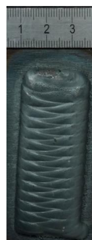
Obr. 3. Vzhled návaru při frekvenci 200 Hz
