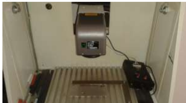
Obr. 4. Galvanoscanner RL-14 D2 – RAYLASE umístěný v boxu
