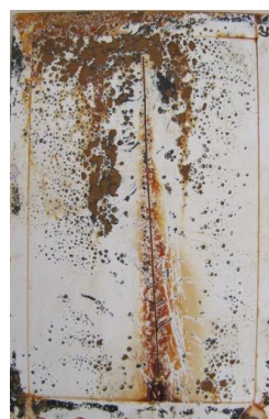
Obr. 2. Ukázka puchýřů na 2. vrstvě vodou ředitelném nátěrovém systému po expozici 150 hodin v solné mlze.
