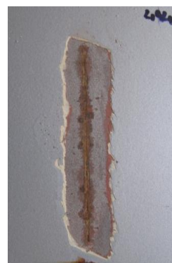
Obr. 1. Vzorek s umělým defektem po expozici 720 hodin v solné mlze (3. vrstvý nátěrový systém).
