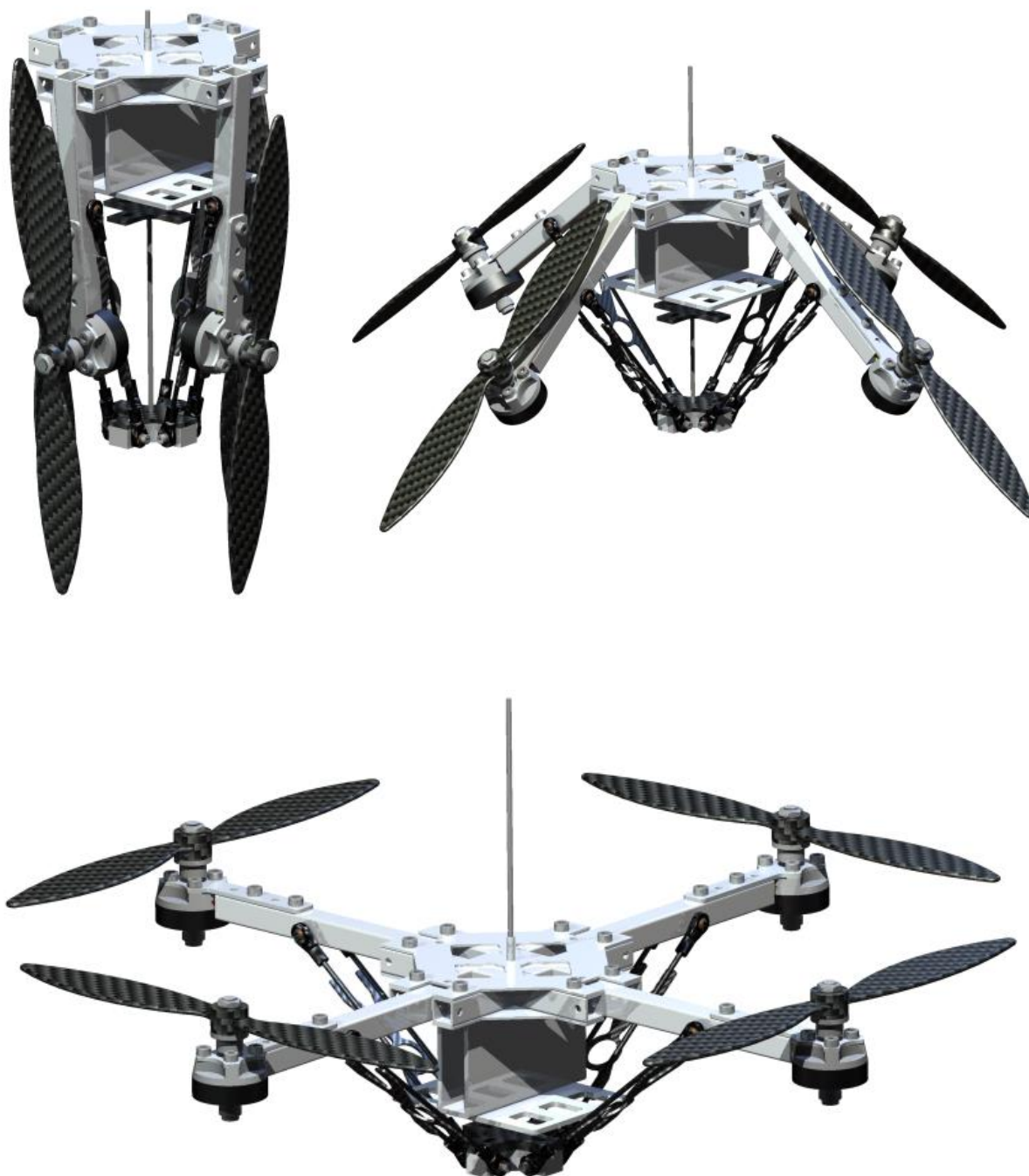
Obr. 1. Rozkládací mechanismus rámu koptery
