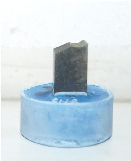
Obr. 3. Příklad fixování metalografického vzorku.
