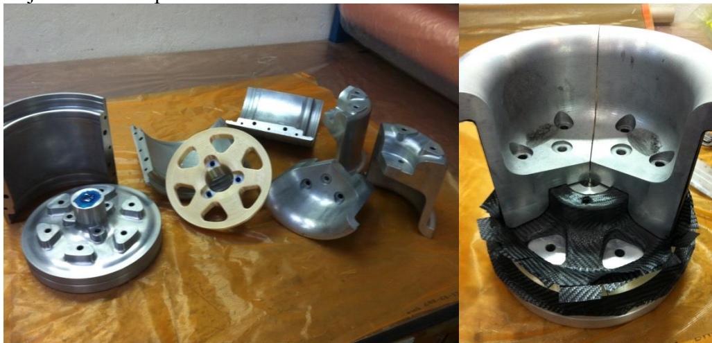
Obr. 7 Obrobené formy a plastové jádro včetně nalisovaných titanových vložek a skládání prepregu.
