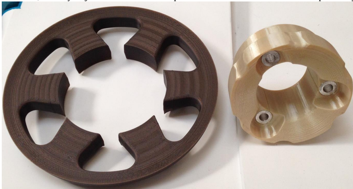
Obr. 12 Dvoudílné plastové jádro nového disku.
