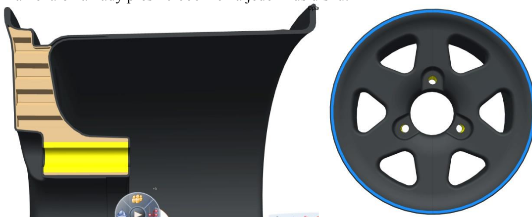
Obr. 3 Detail řezu modelem disku a čelní pohled na model
