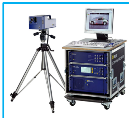
Obr. 1 – Měřicí aparatura PSV-400 pro modální zkoušku
