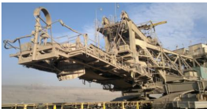
Obr. 2. Shazovací vůz SV 198 firmy transporta, pracující na hnědouhelných dolech v Bílině
