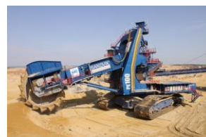
Obr. 5. Kompaktní kolesové rypadlo PE100-1600/1.5x20 firmy Sandvik [9]
