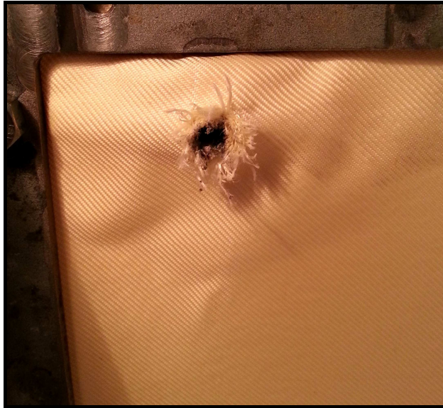
Obr. 10 Dyneema – deformačně ovlivněná oblast Obr. 11 Kevlar – plastická deformace
