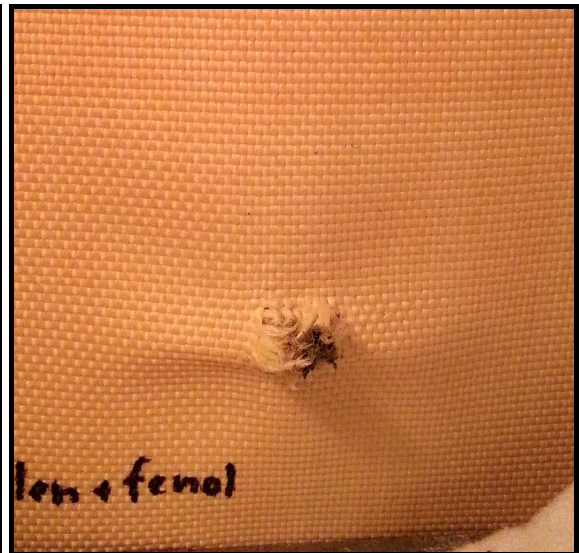
Obr. 12 Tegrís, 2PSF otvor vpravo, 3PSF otvor vlevo Obr. 13 Innegra – plastická deformace
