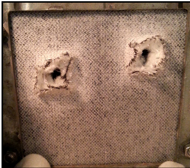
Obr. 12 Tegrís, 2PSF otvor vpravo, 3PSF otvor vlevo Obr. 13 Innegra – plastická deformace
