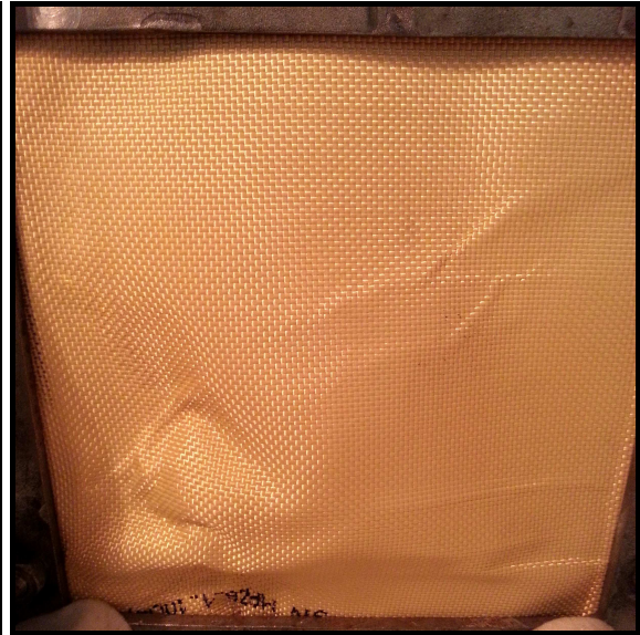
Obr. 10 Dyneema – deformačně ovlivněná oblast Obr. 11 Kevlar – plastická deformace
