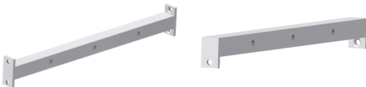
Obr. 4., 5. Ukázka konstrukce příčníku I a II
