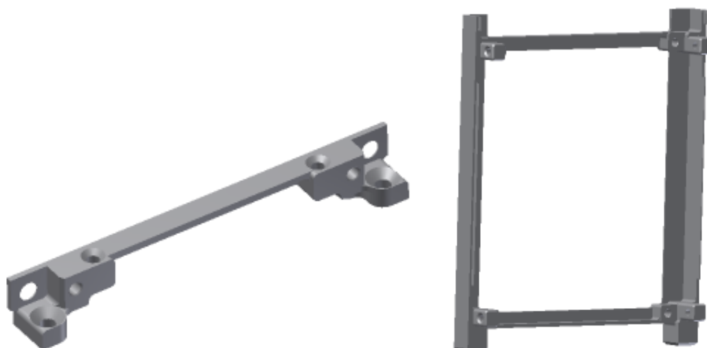
Obr. 8., 9. Součásti Kostry II. – rám a příčník [10]
