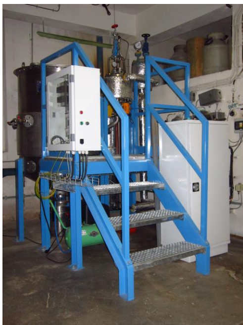
Obr. 3. Laboratorní jednotka termicko-expanzní hydrolyzy [8]
