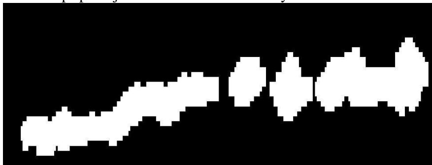
Obr. 10.: Výřez přírůstku trhliny z Obr. 8.
