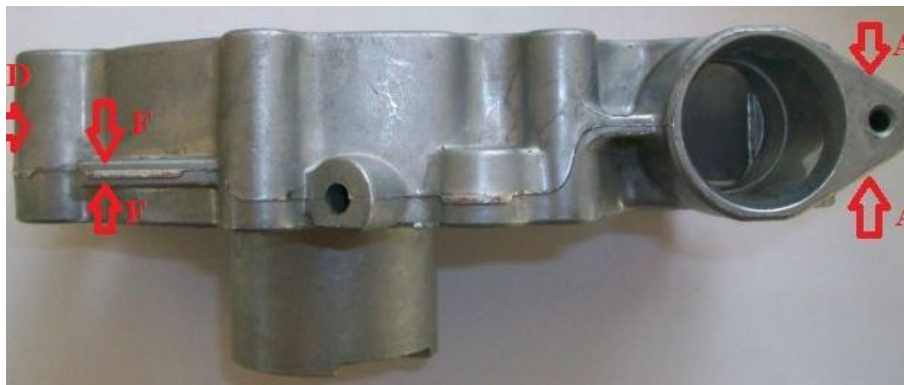
Obr. 3. Odlitek olejového čerpadla s označením možných upínacích ploch, horní pohled.
