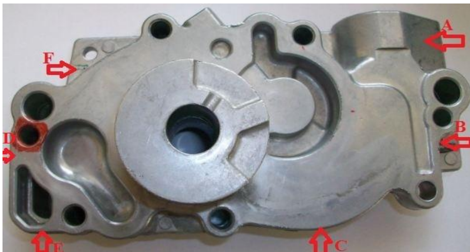
Obr. 1. Odlitek olejového čerpadla s označením možných upínacích ploch, přední pohled.
