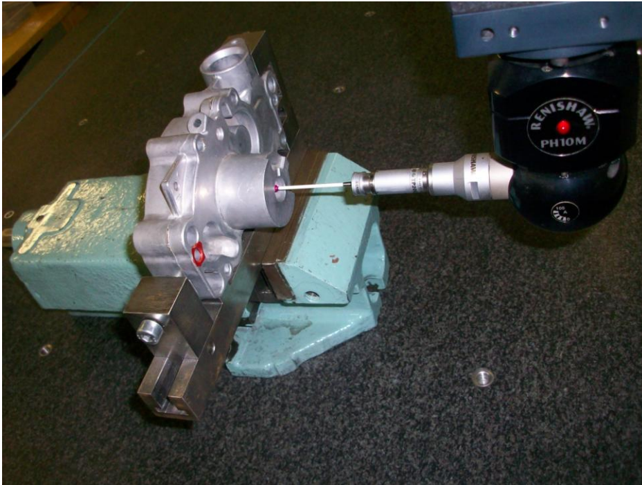
Obr. 15. Měření odlitku na SMS Wenzel LH87
