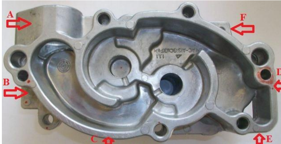
Obr. 2. Odlitek olejového čerpadla s označením možných upínacích ploch, zadní pohled.
