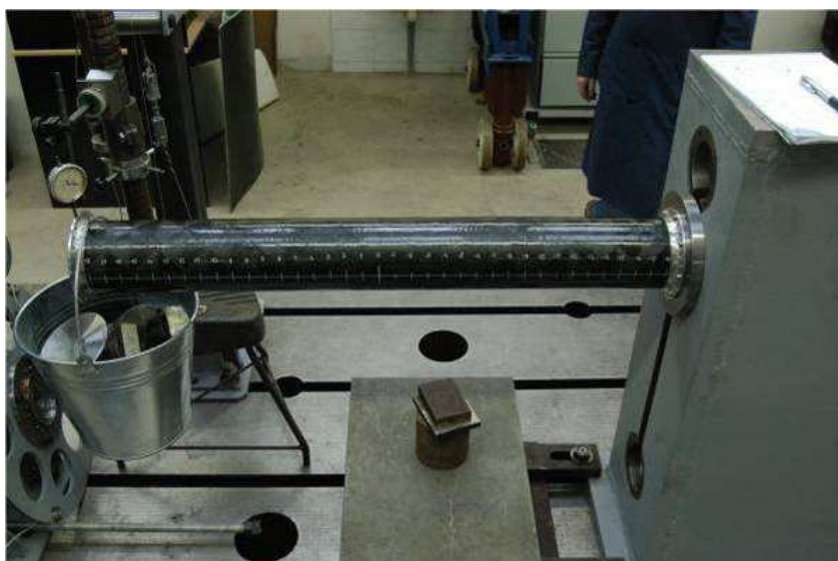
Obr. 5: Zkouška ohybové tuhosti transmisního hřídele [7]
