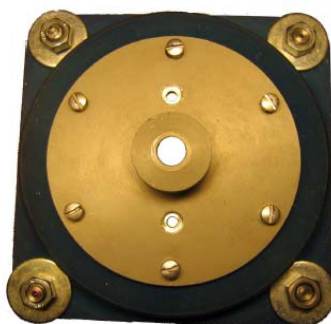
Obr. 8: Přípravek na držení motoru
