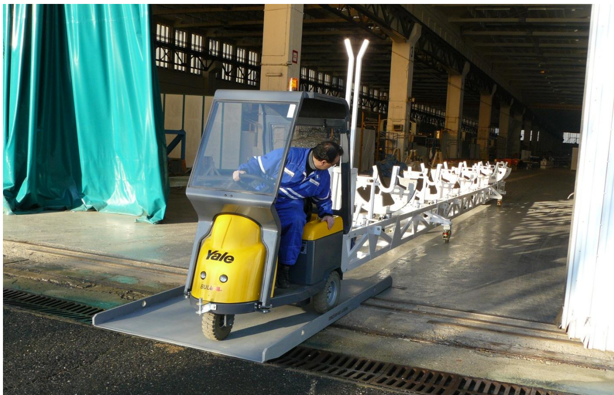
Obr. 11 Proní výjezd tažné soupravy po mostku
