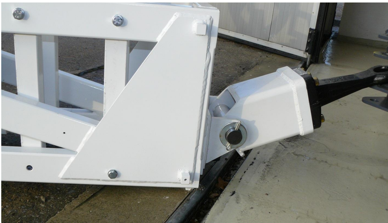
Obr. 13 Kolize Out Jigu s profilem vedení nových vrat lakovny
