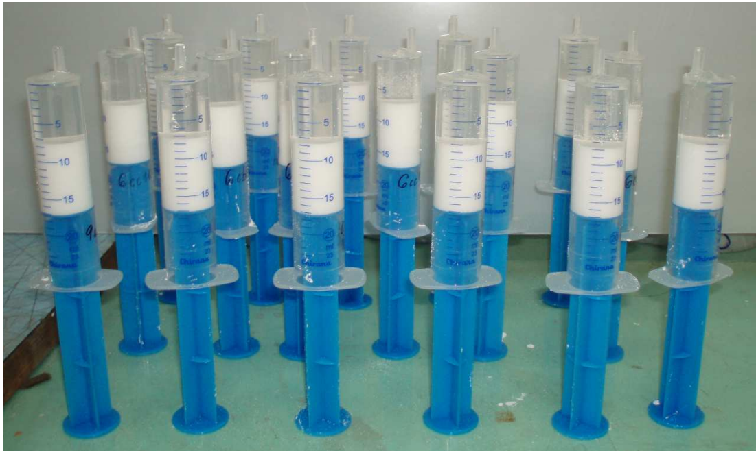
Obr. 7. Výsledky sedimentačního testu odebraných vzorků suspenze PVC při homogenizaci v optimalizovaném míchaném reaktoru.
