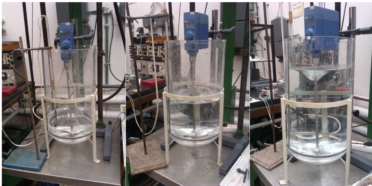
Obr. 3. Ukázka vodivostního měření doby homogenizace při limitních stavech plnění.
