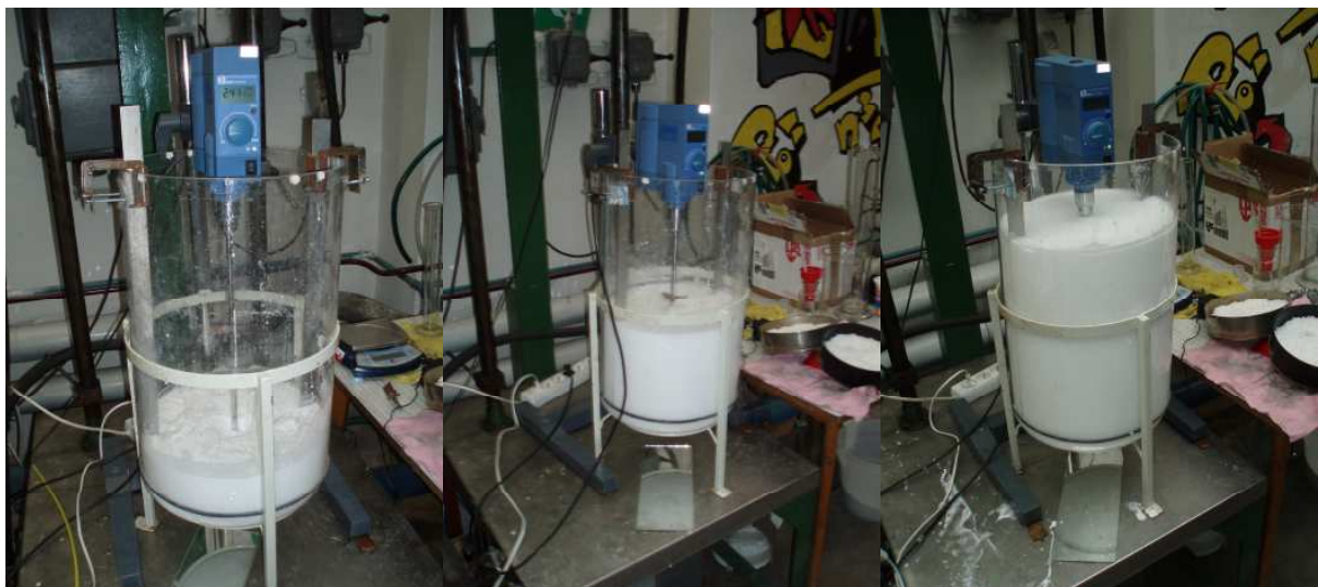
Obr. 4. Ukázka odběru vzorků suspenze PVC v modelu optimalizované konfigurace míchaného zásobníku.
