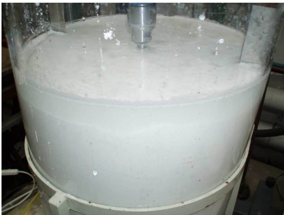
Obr. 11. Nehomogenita míchané vsádky v optimalizovaném míchaném zásobníku s třílopatkovým míchadlem s rovnými lomenými lopatkami s D/d_2 = 4,5 .
