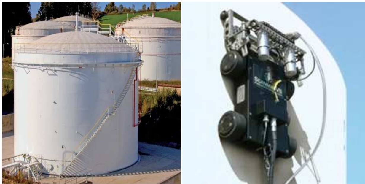
Obr. 1 - Velkokapacitní zásobník (vlevo), mobilní zařízení pro UZ defektoskopii od firmy Silverwing
