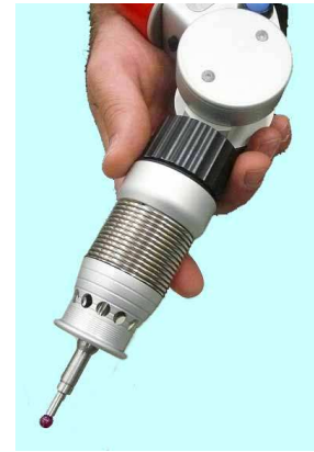
Obr. 4.2 Pevný dotyk sondy ramene [4]
