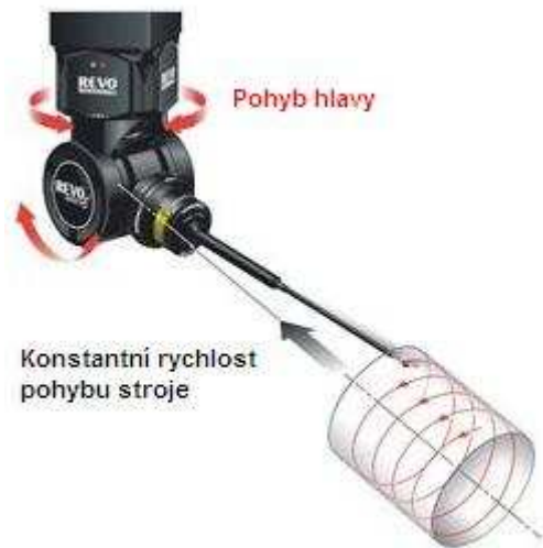
Obr. 3.1 Schéma 5-osého skenování [3]
