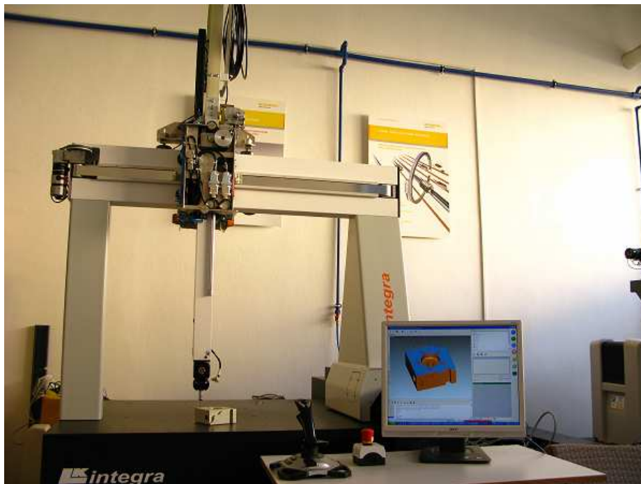
Obr. 1.1 Souřadnicový měřicí stroj LK Integra v laboratoři metrologie
