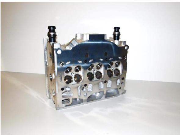
Bild 5 – Teil für den Versuch – Zylinderkopf des Verbrennungsmotors 1,0 MPI
