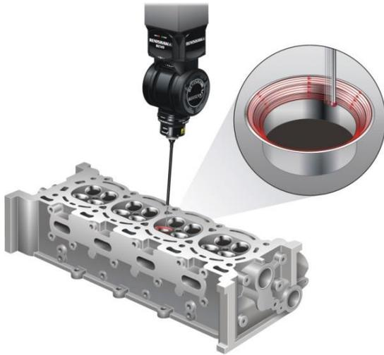
**Bild 3** – Grafisches Beispiel der Messstrategie für einen Ventilsitz am Verbrennungsmotorkopf [5]
