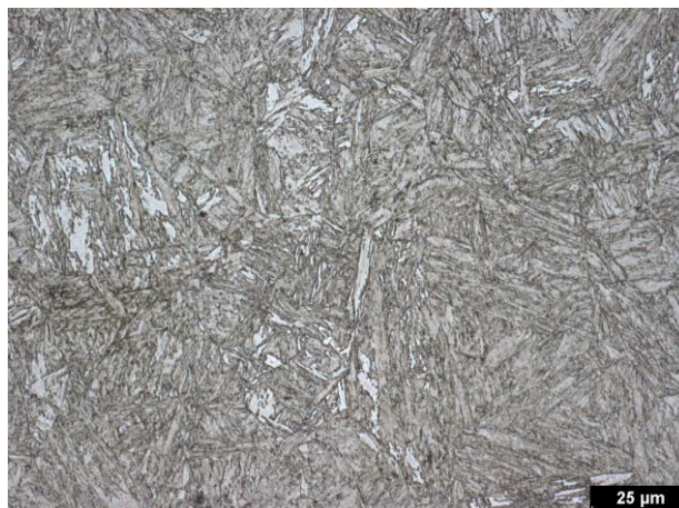
Obrázek 6: Struktura G22NiMoCr5-6, kaleno 950 °C, popuštěno 610 °C, leptáno (Nital)
