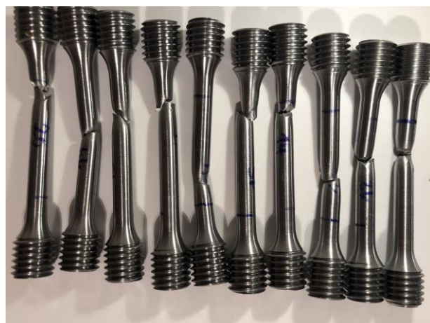
Obrázek 22: Houževnaté porušení všech vzorků pro zkoušku tahem s použitím normalizačního žíhání a TP 560 °C
