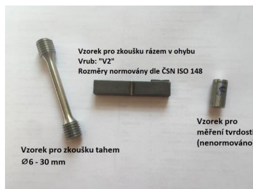
Obrázek 3: Vzorky pro mechanické zkoušky a metalografickou analýzu G22NiMoCr5-6
