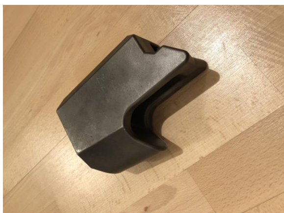
Obrázek 2: Díl vyrobený metodou vytavitelného modelu z oceli G22NiMoCr5-6 (vyznačen na Obrázku 1)
