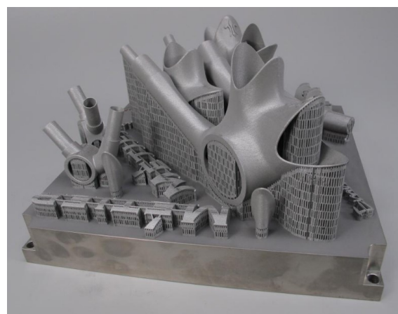
Obrázek 2 - Příklad palety s vytištěnými součástmi technologií DMLS [6]
