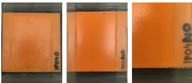
Obr. 16. Systém IP04 před testováním (vlevo) a po ukončení zkoušek po 168 h.
