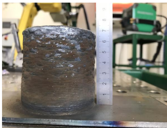
Obr. 10. Strukturovaný návar vytvořený IAC procesem
