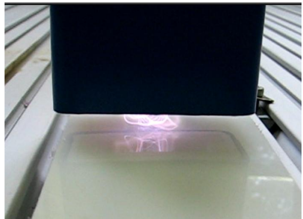
Obr. 3 Tryska pro plazmovou úpravu [2]
