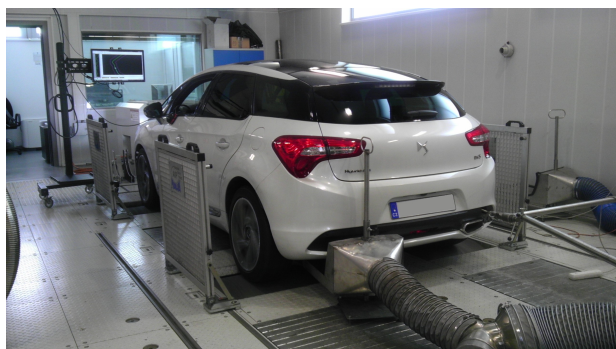
Obr. 2. Vozidlo v průběhu testování na válcové brzdě
