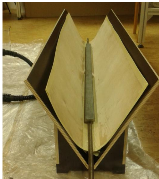
Obr. 5: Přípravek pro ohýbání překližkových plátů na potah křídla včetně zkušebního vzorku
