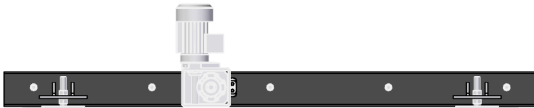
Obr. 9. Vybraná konstrukční varianta válečkového dopravníku s pohonem opásáním – pohled z boku
