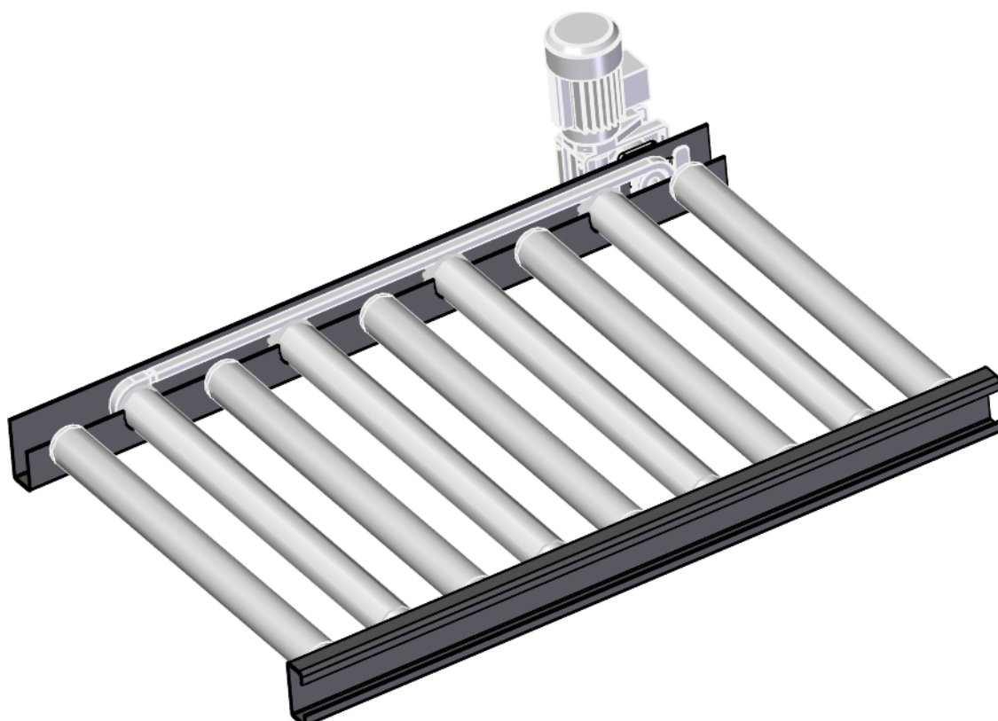
Obr. 2. Modifikace válečkového dopravníku s tangenciálním pohonem
