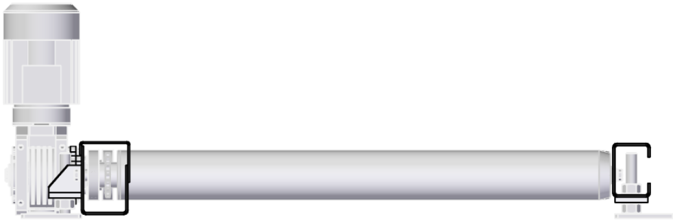
Obr. 8. Vybraná konstrukční varianta válečkového dopravníku s pohonem opásáním – pohled zepředu
