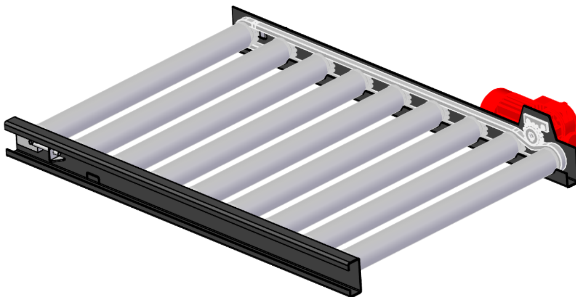
Obr. 1. Konceptce válečkového dopravníku s tangenciálním pohonem
