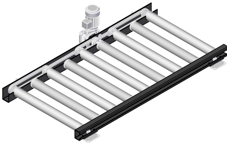
Obr. 6. Vybraná konstrukční varianta válečkového dopravníku s pohonem opásáním
