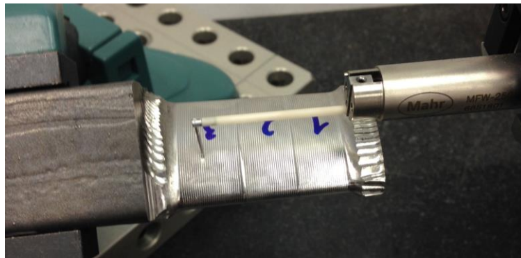
Obr. 3. Měření drsnosti na obroběných lopatkách
