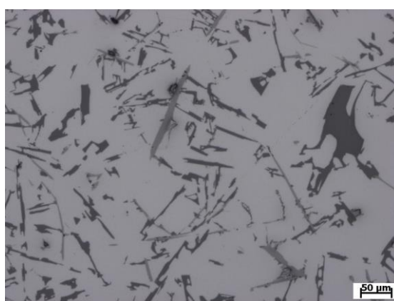
Obr. 11. Mikrostruktura vzorku (0,6 % hm.) z 1. pokusu při zvětšení 100x
