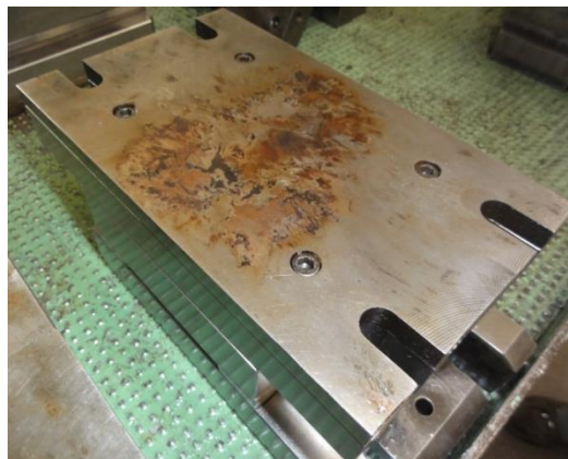
Obrázek 2: Ukázka vibrační koroze na dílci nástroje
