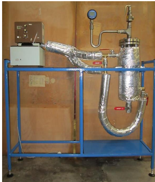
Obr. 17. Zaizolovaný termoreaktor a hadice.
