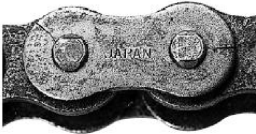
Obr. 7. Poškození řetězu vzniklé působením koroze
