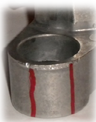
Obr. 1. Zalomená hrana odlitku
