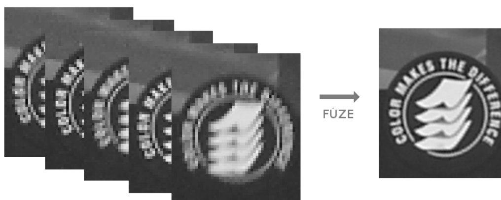
Obr. 5: Znáznornění super-resolution rekonstrukce sady dvaceti černobílých snímků
