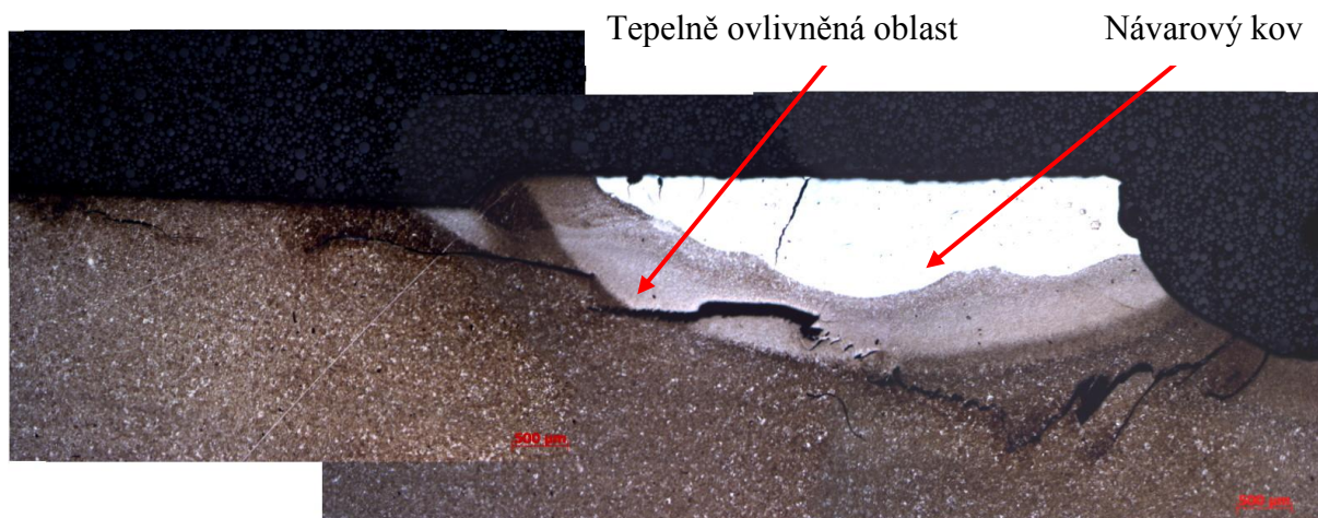
Obr. 4 Detail trhliny kolem návaru v místě 3.2 - zvětšení 25x
