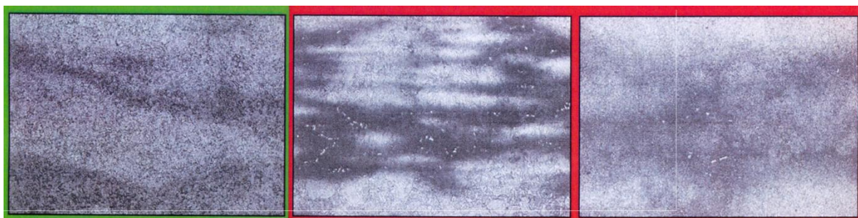
Obr. 1 Příklad přijatelné (Vlevo) a nepřijatelné struktury vzorku (zvětšeno 50x, leptadlo Vilella)
