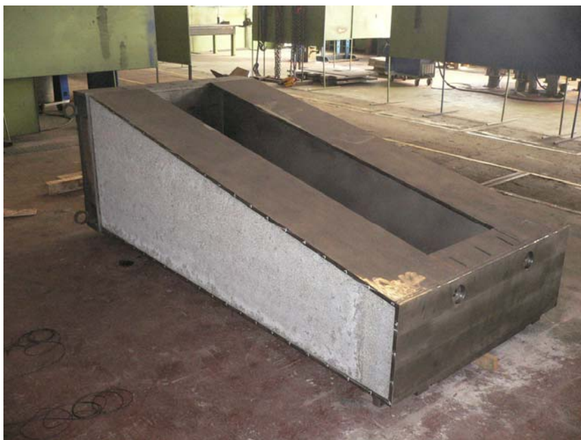
Obr. 14. Stojan s vlepeným blokem hliníkové pěny před montáží bočnic
