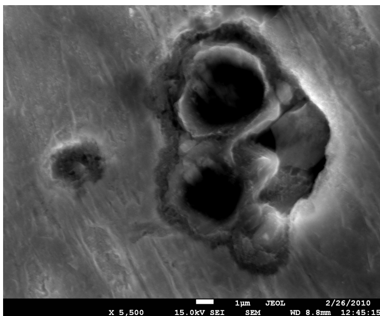
Obr. 14. Oxid hliníku s přechodovou oblastí vyloučeného AlN zvětšeno 5500x
