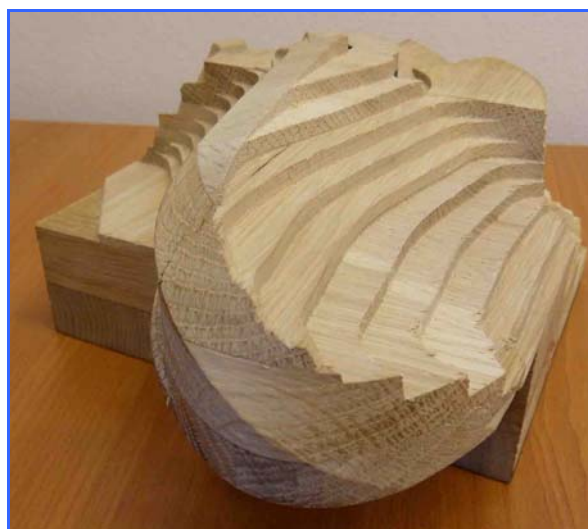
Obr. 10 Obrobená plocha pro měření posuvových rychlostí laserovým senzorem
